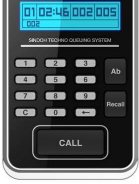
이더넷, 무선(RF) 표시부 호출번호, 대기인수, 대기시간, 업무번호 기능 - 호출 / 재호출을 통한 고객을 호출 - 업무 변경 - 부재중 설정 - 백라이트 ON/OFF - 임의 호출 호출, 재호출, 업무 변경, 부재중, 10key 버튼부
